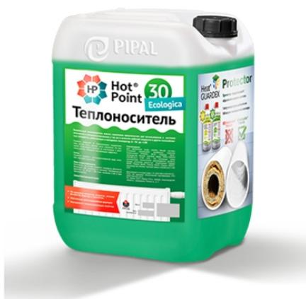
Теплоноситель "HotPoint® 30 Ecologica " предназначен для использования в автономных системах отопления замкнутого типа, работающих в интервале температур от минус 30°С до плюс 106°С. Теплоноситель надежно защищает от коррозионного воздействия медь, припой, латунь, чугун, сталь, алюминий. Не агрессивен по отношению к пластиковым и металлическим трубам, сантехнической резине и прокладкам. Снижает энергозатраты благодаря своим стабильным теплофизическим свойствам.
