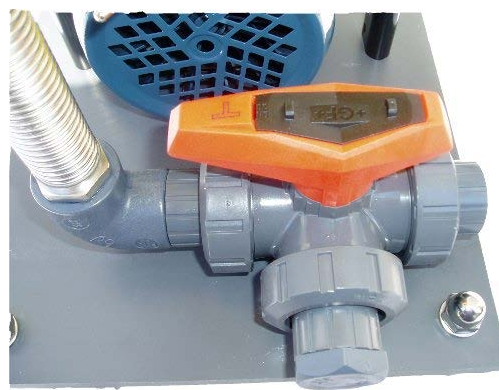
Клапан в положении CIRCULATION (ЦИРКУЛЯЦИЯ)
